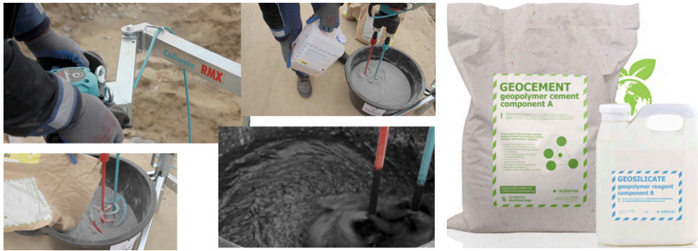
Hình 2. Nghiên cứu và phát triển về vật liệu và quy trình công nghệ in 3D sử dụng bê tông geopolyme [4]
